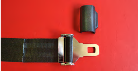
Abb. 7 Das Gurtband über den Spannblock wieder zurück durch die Gurtzunge fädeln.
