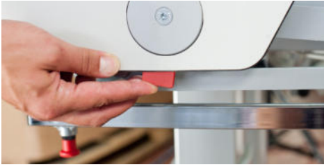
Arretierung der Seitenblende gelöst
